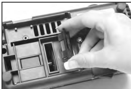
Obrázok 14. Ak má vaša čepeľ výrazné zhrubnutie, môže byť užitočné umiestniť pri brúsení prst za ňu, ako je znázornené.
