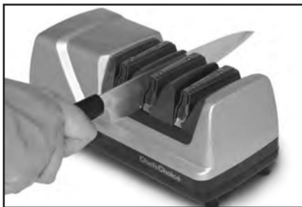
Obrázok 8. Brúsenie tradičného japonského noža pre pravákov v 2. fáze.
